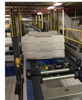
ramasser leurs bagages inspectés. En matière de capacité, le nouveau système peut traiter 2 000 bagages par heure du côté des vols domestiques, et 1 000 bagages du côté des vols transfrontaliers, soit deux fois plus que l'ancien système. Pour ce qui est de la consommation énergétique, le système consomme moins d'énergie bien qu'il soit deux fois plus grand que l'ancien, ce qui est bénéfique à l'environnement et à notre communauté.
